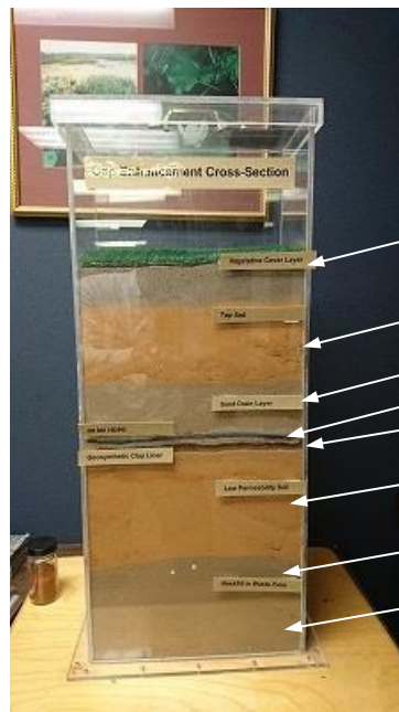
図 2.(3)-3 バーンウェル処分場のバリア構成
