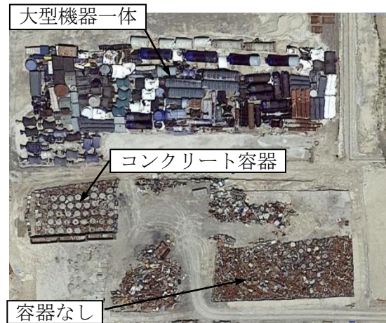
(4) 廃棄物埋設状況 (上空写真)
