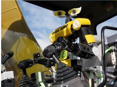
遠隔操作による無人化施工
