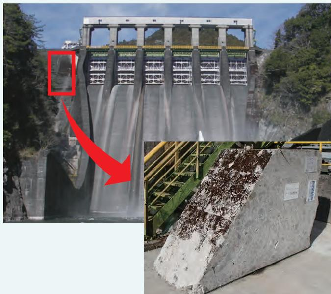
ダムの再開発で堤体を切削した際に発生したコンクリートのブロックです。竣工から50年以上経過したダムにおいてもダム堤体コンクリートは、健全性が保たれています。
