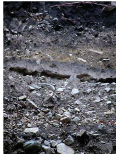
図 7.2.1-8 中坪上沢の土石流源頭部の崩壊斜面（左：全体，右：横断中央部の火山灰層付近の拡大写真）
