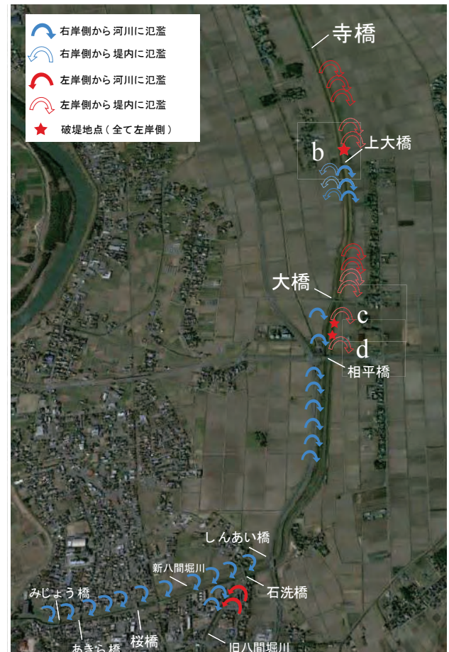
図4.5-1 八間堀川における越水・破堤現象
