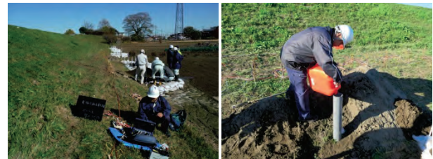
電極打設式電気探査
