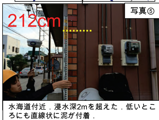
図 3.3.1-3 氾濫域における痕跡浸水深および浸水状況
