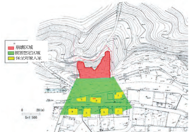
図7.1-5 広久保IB地区被災箇所平面(赤色部崩落箇所)
