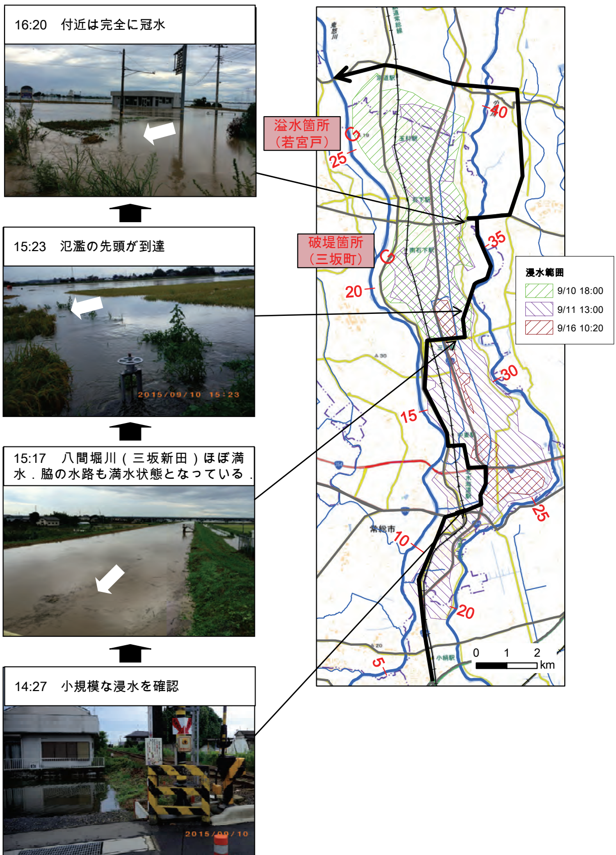
図 3.3.1-2 9/10 の浸水状況と初動調査ルート
