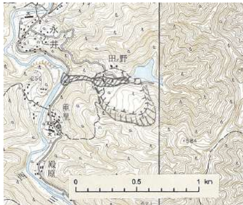
図7-4-1 重里新湖を形成した崩壊堆積物と今回の崩壊および土石流範囲（斜線部）
