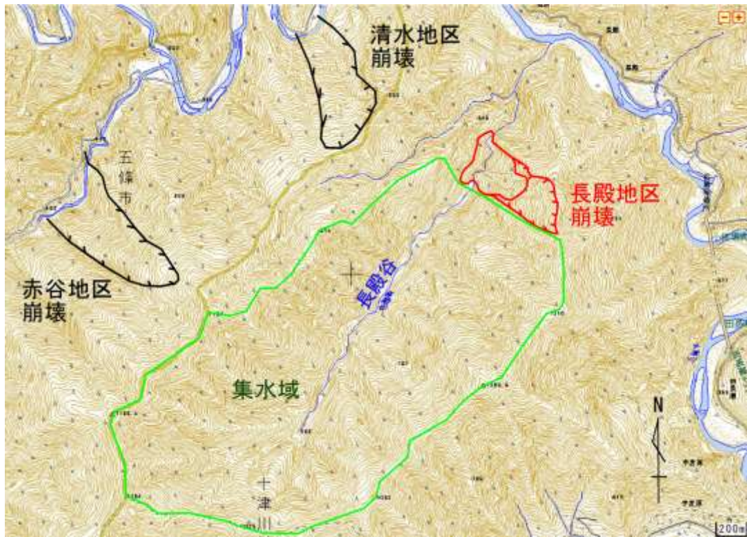
図 5-1-1 長殿地区斜面崩壊箇所の周辺状況（崩壊前の地形図，国土地理院発行の地形図（1/25,000）を利用）
