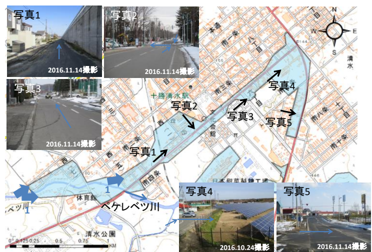
図 4.3.3 清水市街地における水の流れを支配した 主な地形と施設
