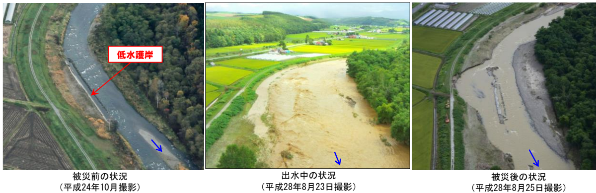
図 3.2.1 河岸侵食状況 (KP7.2 右岸, 提供: 北海道開発局)
