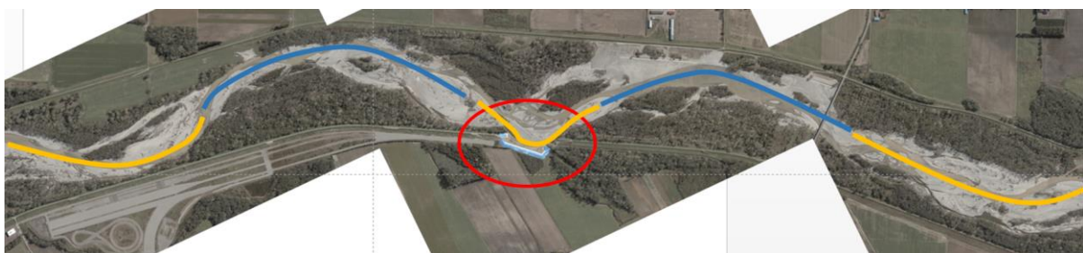
図 4.2.4 堤防侵食区間付近の蛇行流路の波長変化
