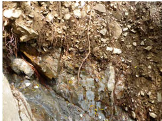
写真 3-3-5-25 基岩と堆積層の境界からの湧水
