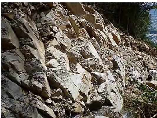
写真 3-3-5-44 高角流れ盤をなす節理が発達する露頭状況
