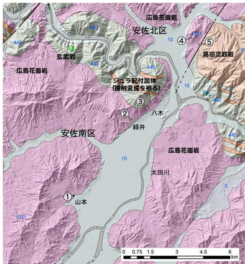
図 4-1-10 被災地の地質図（産総研地質調査総合センターHP「平成 26 年 8 月 20 日に広島市で発生した土石流及び斜面崩壊の発生地に関する地質情報」より）
