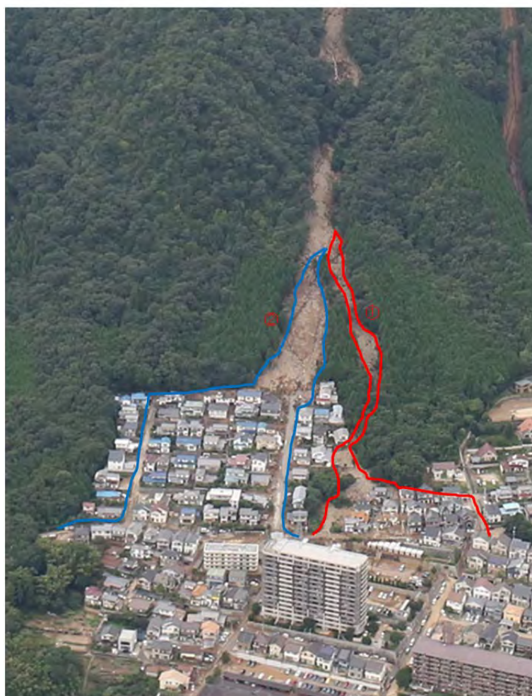
図 3-3-5-2 八木三丁目 阿武の里団地に流下した土石流の分岐・氾濫状況 (8月20日撮影の国土地理院の斜め写真に加筆)
