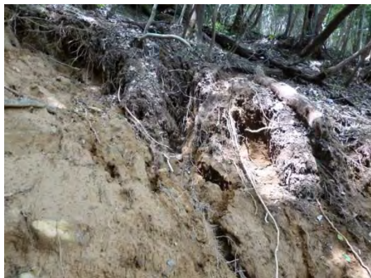
写真 3-3-5-31 源頭部に見られた孔状地形
