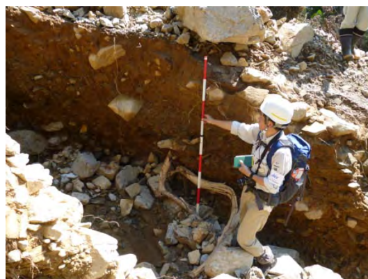
写真 3-3-5-4 土石流によって削り取られて できた溝 (底に過去の土石流堆積 物が見られる)
