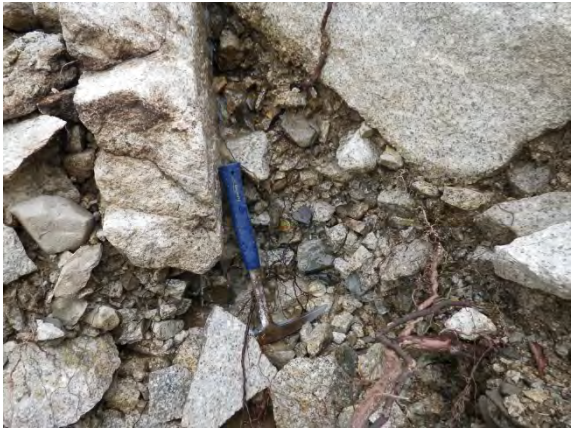
写真 3.3.6-7 崖錐堆積物はよく締まっているが, マトリックスに乏しい箇所もある
