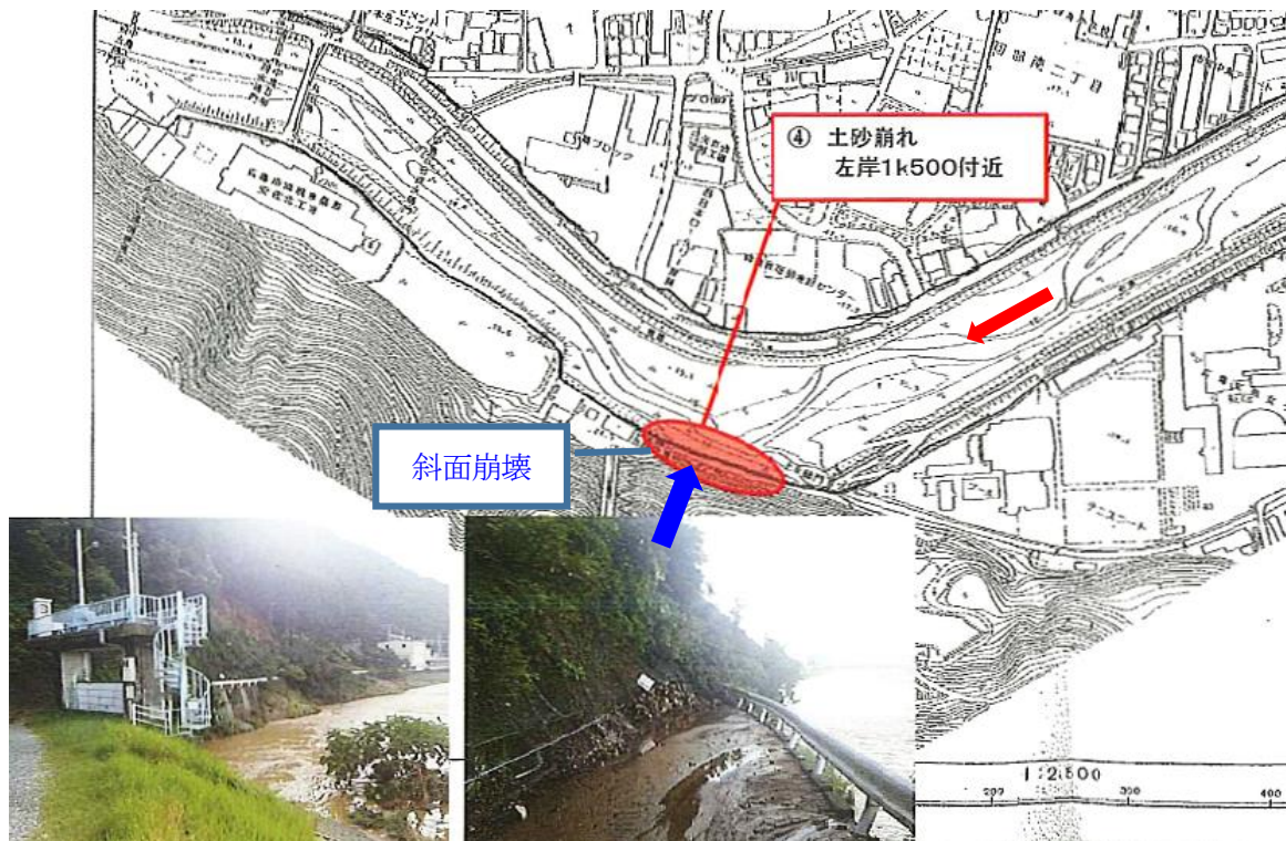
図 3-3 根谷川右岸での斜面損傷
