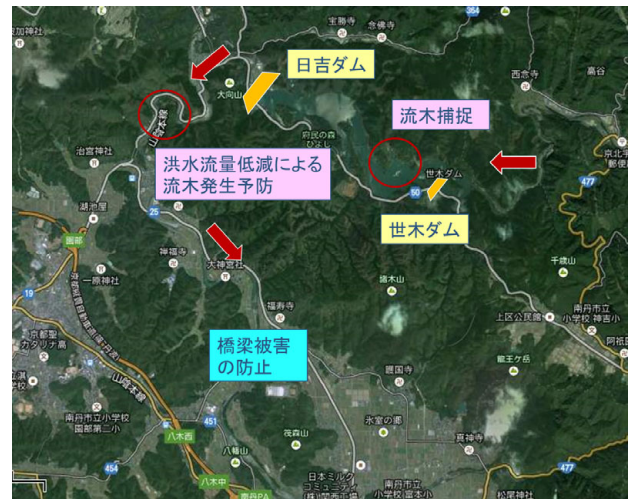
図-24 日吉ダムにおける流木災害に伴う洪水氾濫の防止効果
