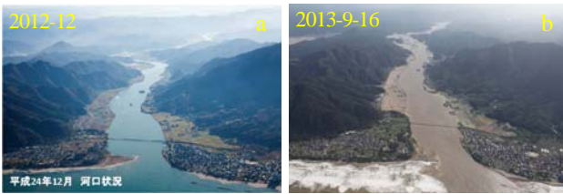
図-16 平水時と洪水時の河口砂州 (国交省福知山提供)
