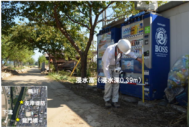
写真-1 京都市伏見区下鳥羽付近での鴨川左岸堤防上の浸水高
