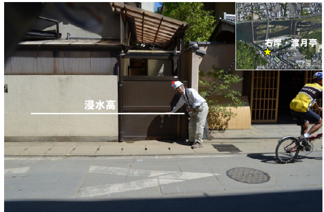
写真-3 桂川右岸（渡月亭付近）での浸水高
