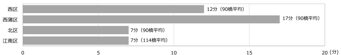
図 7.2.3 過去 4 行政区タブレット点検の一橋あたりの平均点検時間 (踏査と移動時間を含む)
