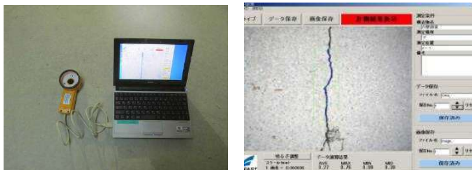
図5.4.3 ひび割れ幅測定器 (CRACK_VIEWER)
