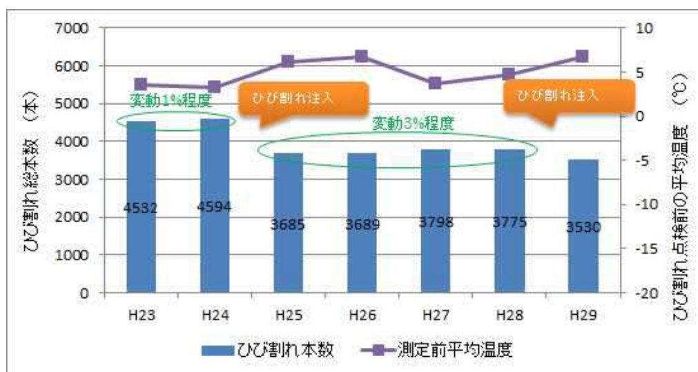
図3.2.9 計測ひび割れ総本数の推移
