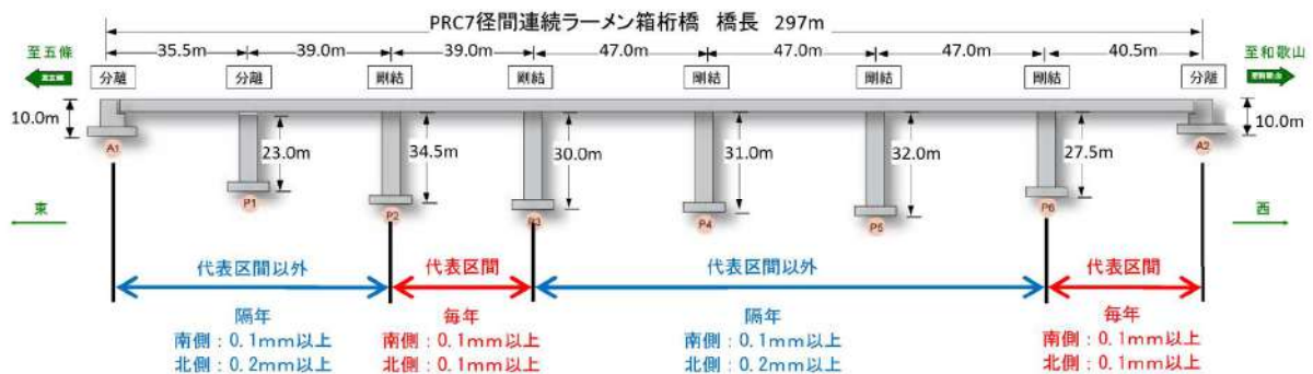
図 2.2 ひび割れ点検箇所図
