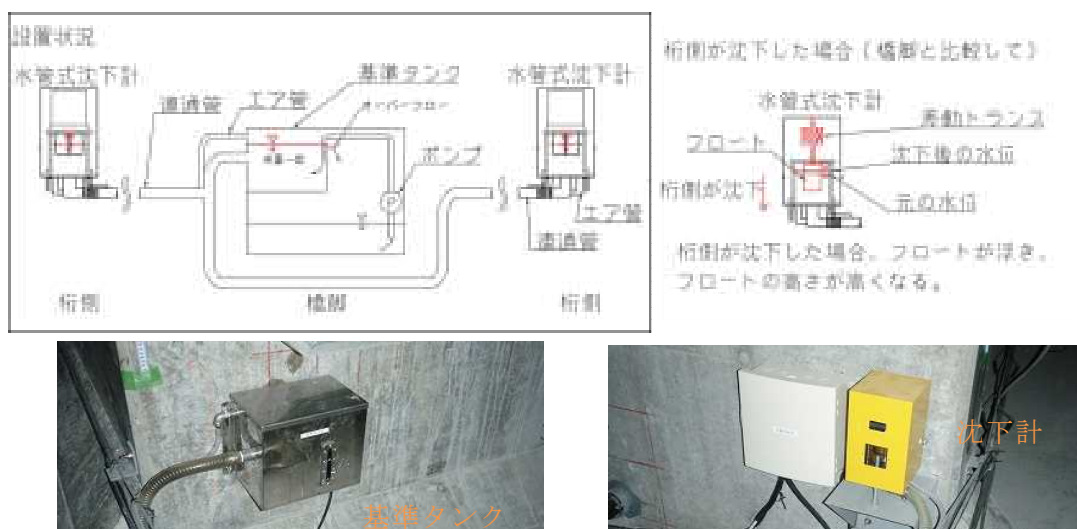
図5.1.6 水管式沈下計の概要図及び写真
