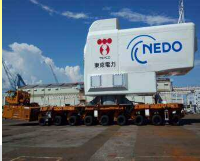
一体組されたナセル (MWT92洋上実証機)
