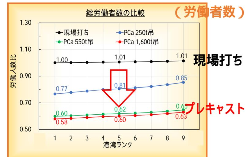
【**栈橋上部工**工事を想定したプレキャストと現場打ちの定量評価と選定フロー】
