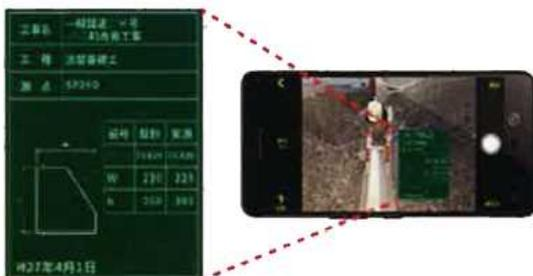
写真管理・出来形管理システムは連動しており、写真の分類と同時に出来形管理表を作成
