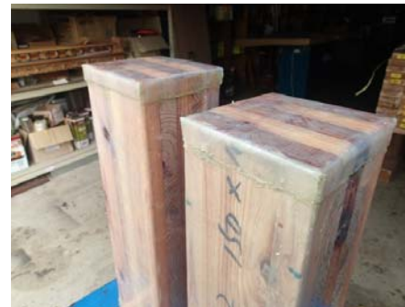
図-9 FRP でラッピングした試験体
