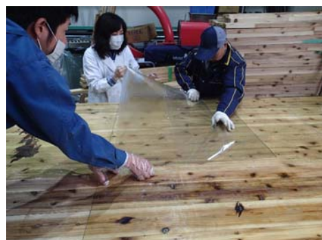
図-5 FRP シートによる実大 CLT のラッピング
