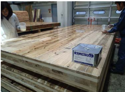
図-6 ウレタン樹脂による被覆処理
