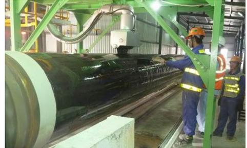
写真3 現場内仮設備に塗布されたSLコンパウンド（輸送時や仮置き時の軟化やダレを防ぐ）
