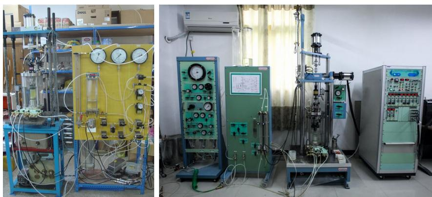
写真 1 上海交通大学土質試験装置 (微小ひずみ三軸、中空ねじり)
