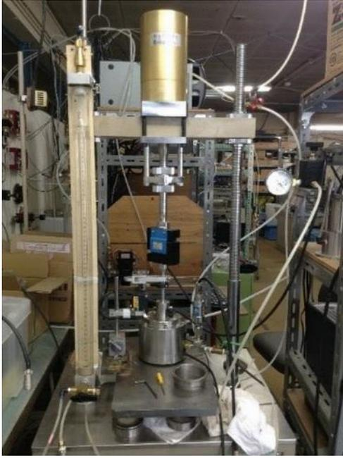
膨張性粘土に対する吸水膨潤圧試験
