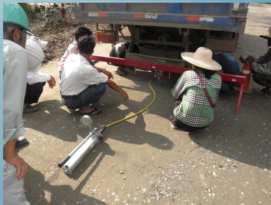
ハード路肩の平板載荷試験
