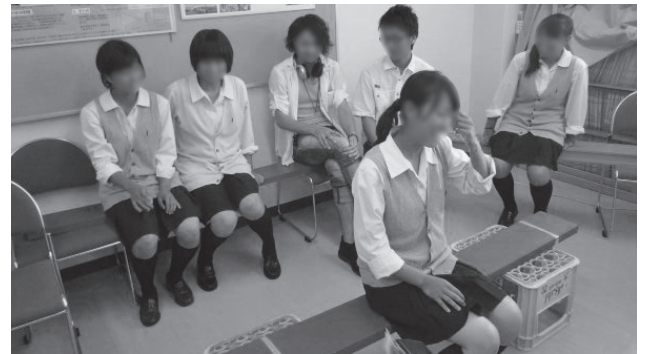
(b) 重ねばり模型(手前の1つのはりと奥の2つのはりに座ってたわみの違いを実感)
