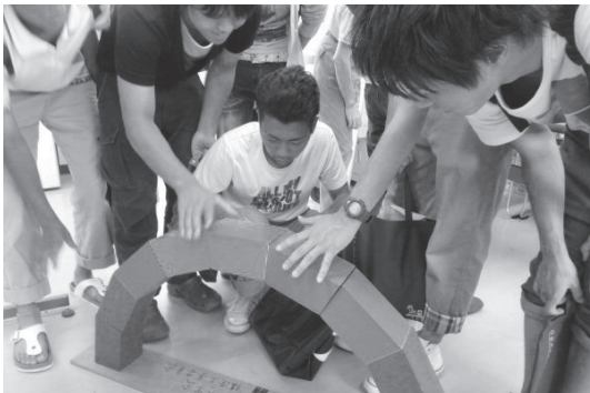
(a) アーチ模型(ブロックを組み合わせてアーチを作成)
