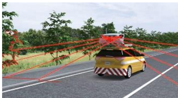
計測車両MMSIによる計測状況
