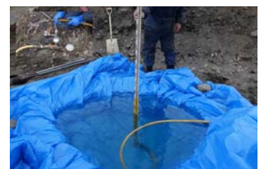
写真 2 現場密度試験/水置換状況
