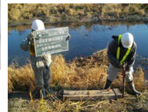
起振状況: 人力による板たたき法でS波を発生。
