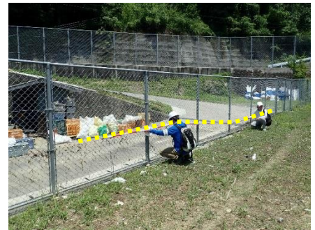
写真2-8-10 ②地点の水深変化痕跡
