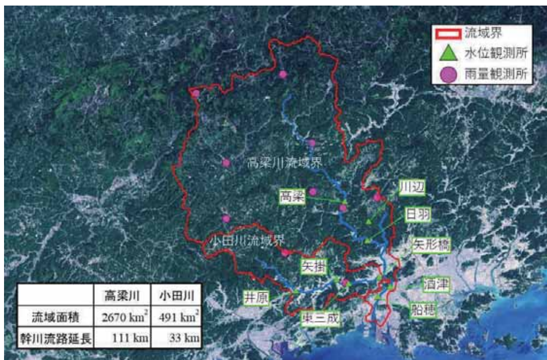
図 3.7.1 高梁川・小田川流域及び水位・雨量観測所の位置
