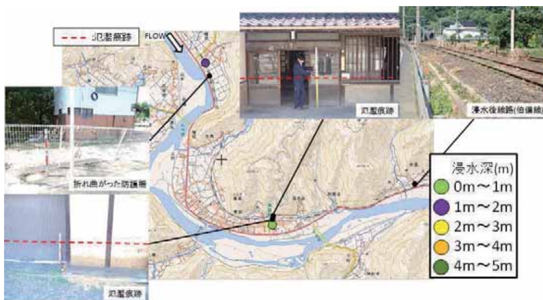
図 3.5.31 美袋地区における浸水状況 (内水氾濫)
