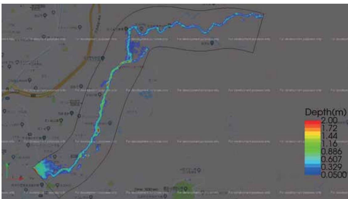
図 6.3.9 Nays2DH を用いた氾濫流解析結果（計算開始から 1010 秒後）
