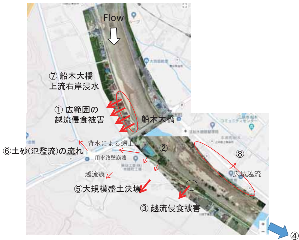
図 4.6.16 船木大橋上下流における沼田川の洪水後の状況と氾濫の概要
