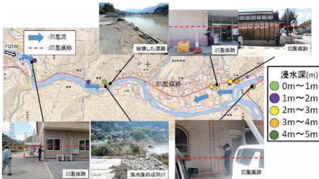
図 3.5.33 落合阿部地区における浸水状況
