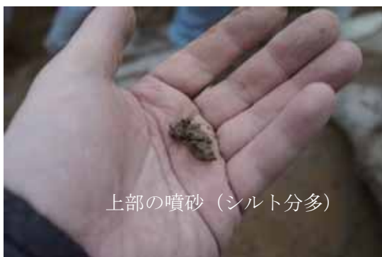
図 5.1.15 侵入した噴砂
