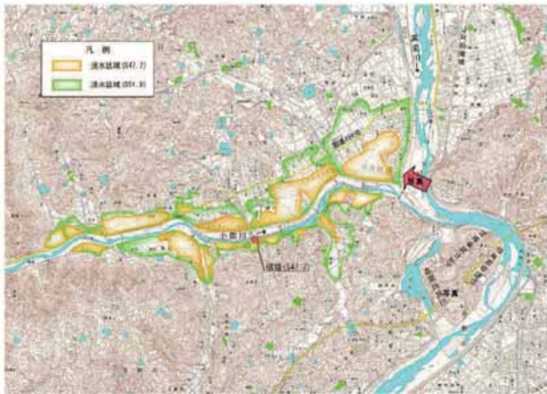
図 3.5.11 真備地区における既往の浸水被害状況（昭和 47 年，昭和 51 年） （岡山河川事務所作成，高梁川河川整備計画より抜粋）
