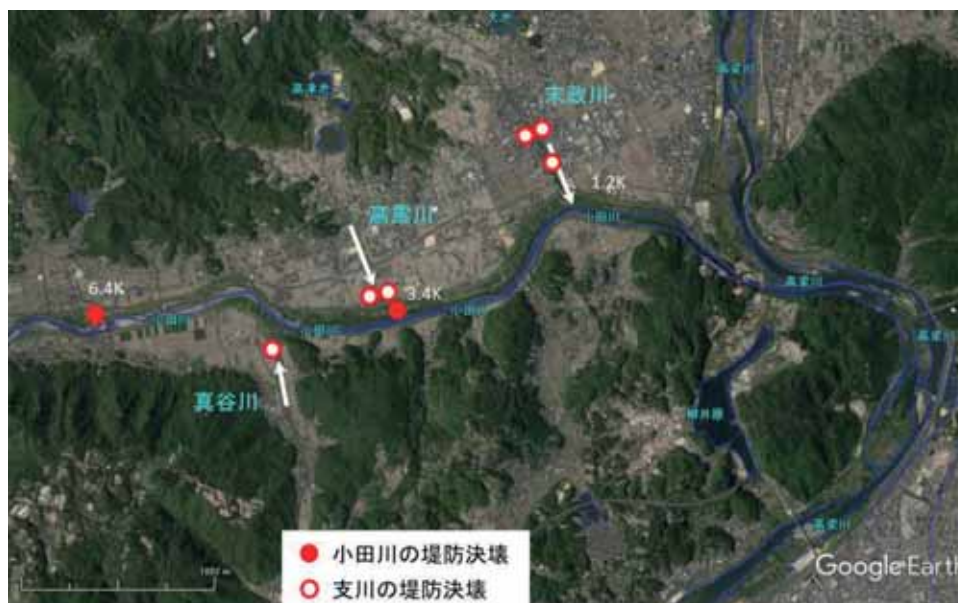
図 3.5.8 真備地区周辺の河川における堤防決壊状況
