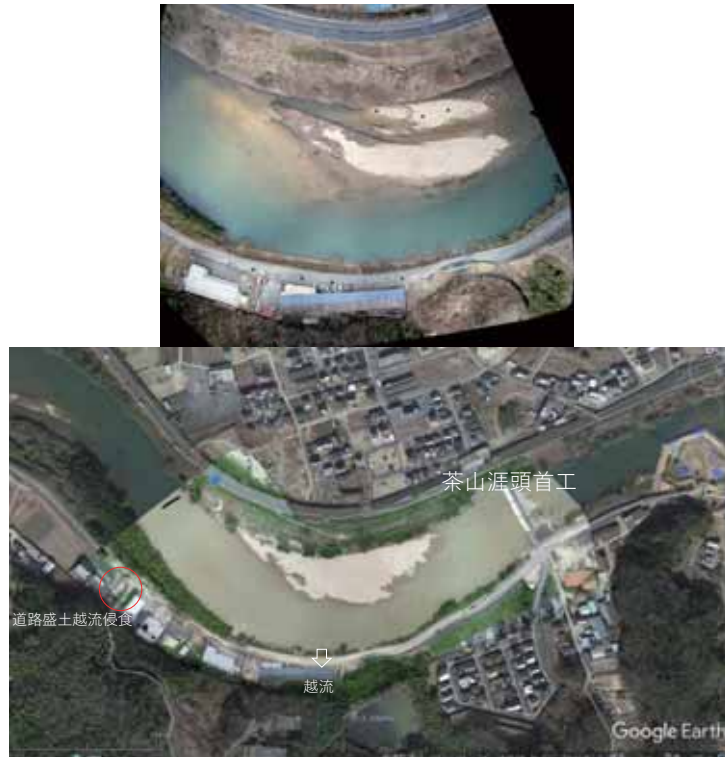
図 4.6.26 茶山涯頭首工上流湾曲部の洪水前（上2018.3撮影），洪水後（下2018.7撮影）の様子
