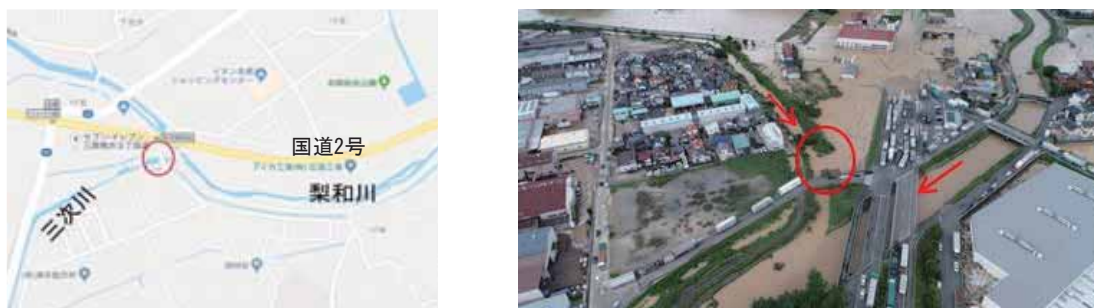
図 4.6.53 三次川左岸の破堤位置と浸水状況
