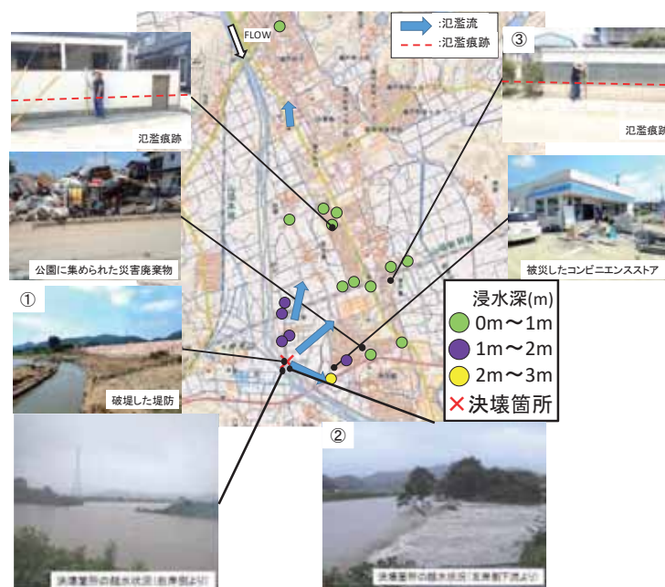
図 3.4.8 平島地区における河川被害と浸水分布（岡山県 写真提供）
