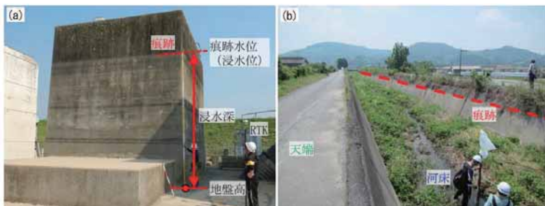
図 3.7.5 洪水痕跡調査の状況（氾濫域(a)と河道内(b)）
