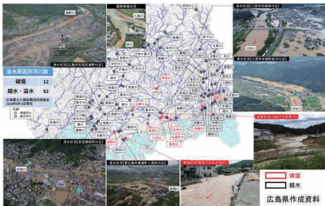
図4.1.1 広島県管理河川の被災状況 1) (一部改変)
