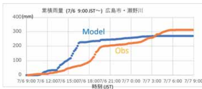
図 2.1.18 降雨時系列の比較. 雲物理過程 WSM 6class と実測雨量との積算雨量による比較.
