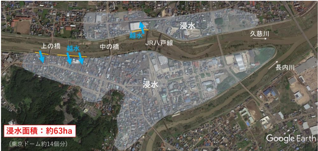
図 4-3 久慈市市街地における越水箇所および浸水範囲
