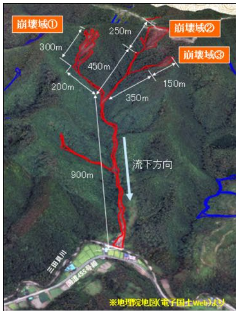
図 6-7 根岸地区で発生した崩壊を起源とする土石流
