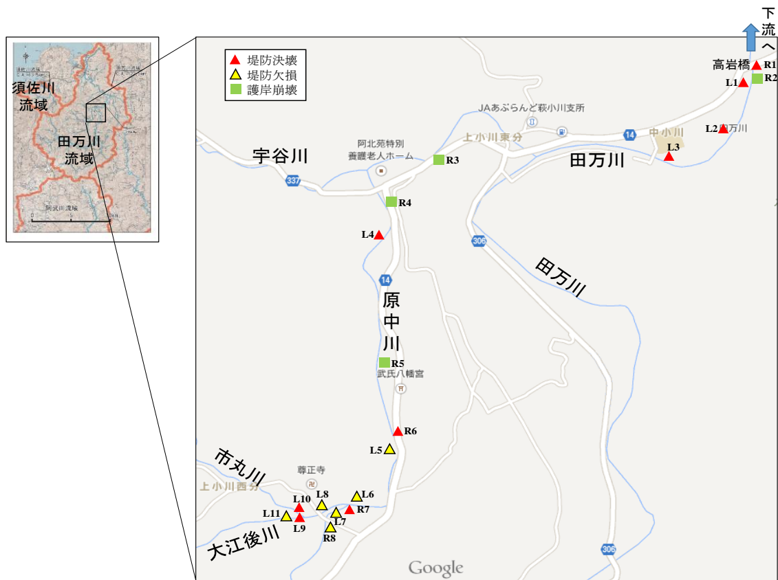
図 4-32 田万川中流部での堤防・護岸の被災マップ（地点名の R は右岸，L は左岸を示す）
