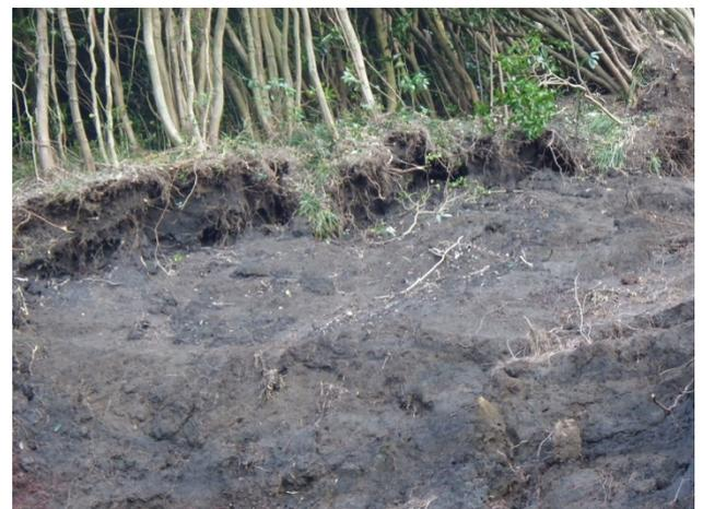
写真6.1-2 Loc.1 表層崩壊部 (表層でパイピング)
