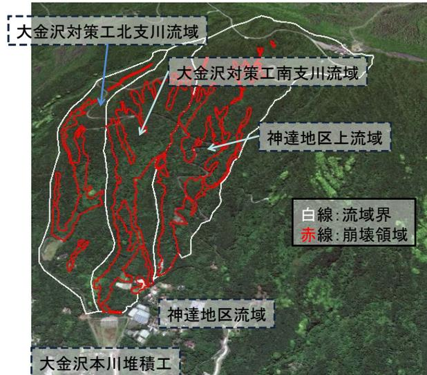
図5.6-3 崩壊領域 (Google earthの画像を用いて作成)
