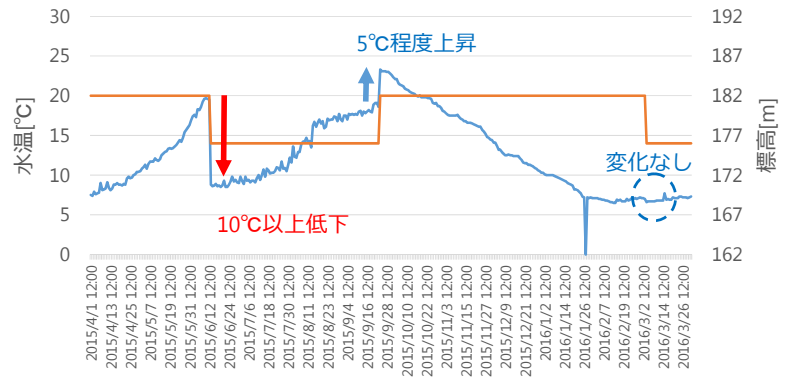
図2 2015年度におけるNダム貯水池の取水口高さと同放流水温の変化
