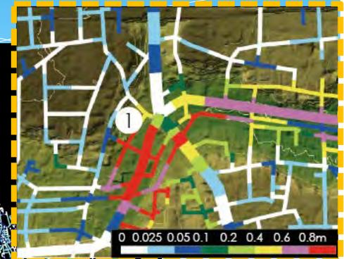
注目する道路点①における浸水深ハイドログラフとManhole点②③における満管率ハイドログラフ
