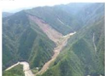
写真. 赤谷川流域の崩壊地と下流への土砂流出の様子
