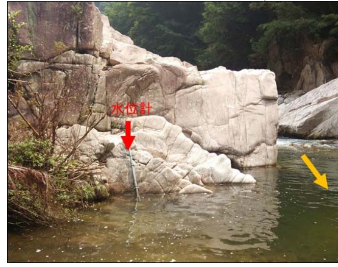
5.8km地点の水位計設置状況
