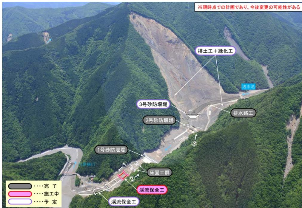
図. 赤谷川流域の砂防施設の配置計画(平成29年現在)
