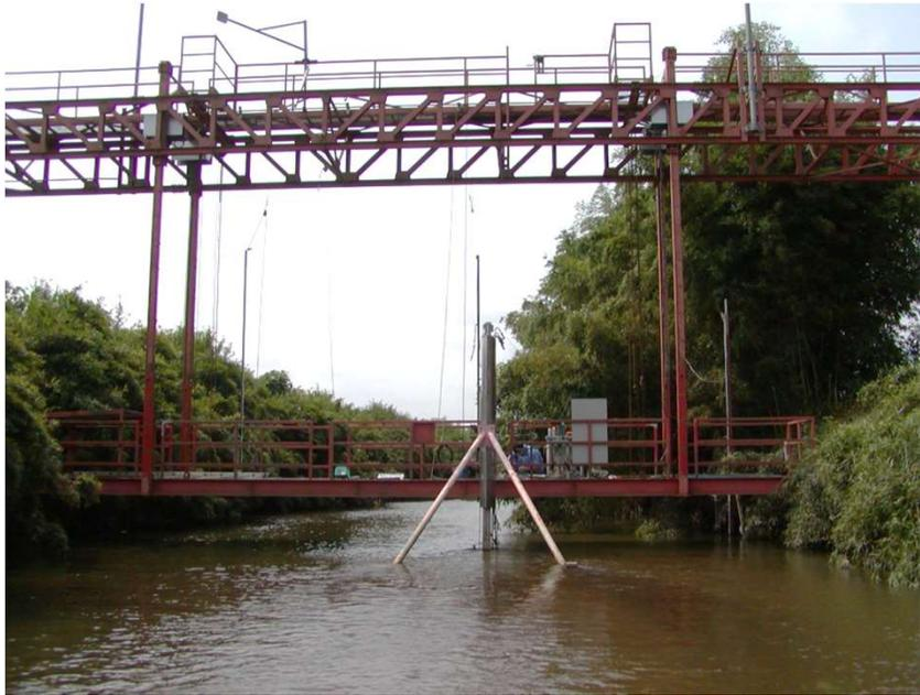
洪水水位に応じて昇降台が上下でき、水位、流量、流砂量、流速分布等の測定ができる。
