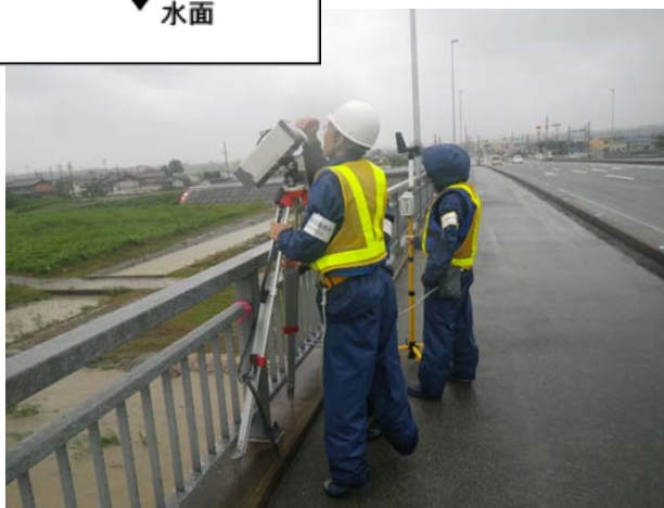
可搬式電波流速計の観測状況
