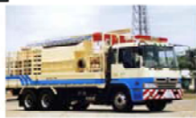
▲ 排水ポンプ車の配備
