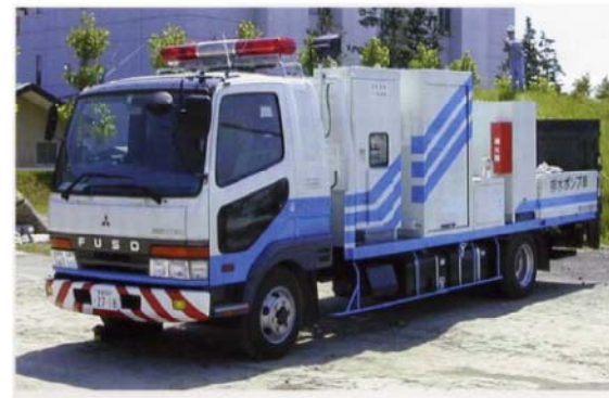
■排水ポンプ車(30m 3 /min級) ▼全景
