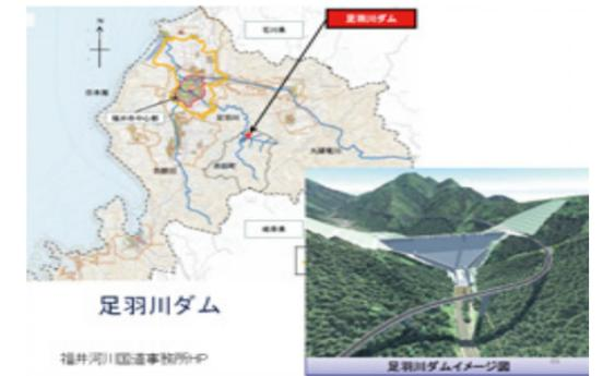
足羽川ダムは足羽川の上流のこの位置に建設されます。通常は水を貯めないで洪水の時だけ水を貯める流水型ダムという形式で建設されます。
