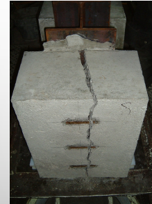
貫通鉄筋無場合の コンクリートの割れ
