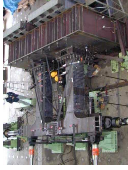
鋼製ラーメン橋脚の実験例 1)
