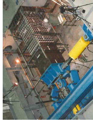
鋼製橋脚の正負交番載荷実験の例 (写真提供：土木研究所)
