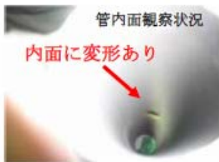
水冷壁側部管左側損傷
