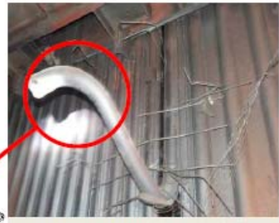
火炉出口部側壁管(缶右)損傷
