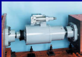
高層ビルの制震 に用いられてい る鹿島のセミアク チブダンパー
