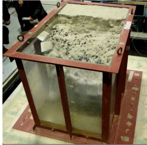
(d)本震：上方部の崩壊
