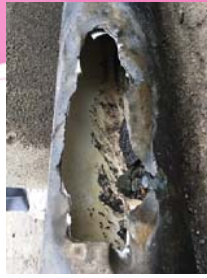
写真1 老朽化による配水管の漏水跡
