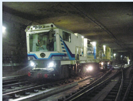
営業列車運行後に走行するレール削正車
