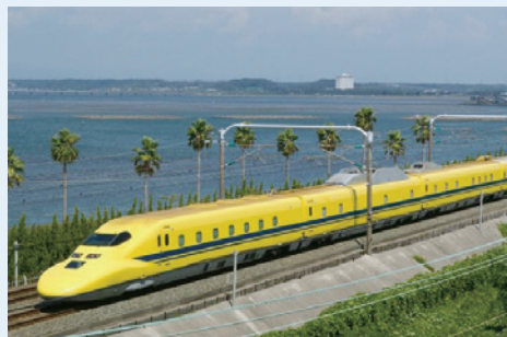
軌道や電気設備の状態を把握するため走行するドクターイエロー
