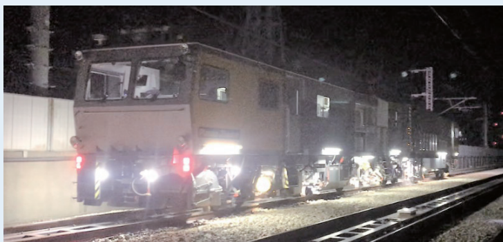
線路のゆがみをまっすぐに直す機械 (マルチブルタイタンパー) です。
