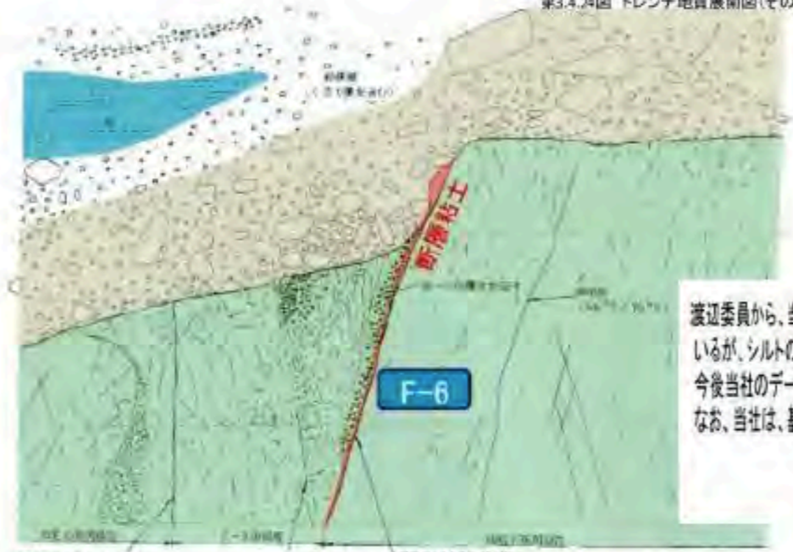
第3.4.22図 トレンチ地質展開図(その3)(北西側側壁基部スケッチ)
