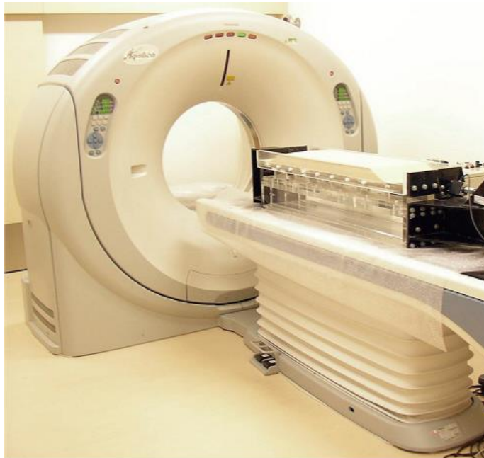
（ベッド上は横ずれ断層模型実験装置）
