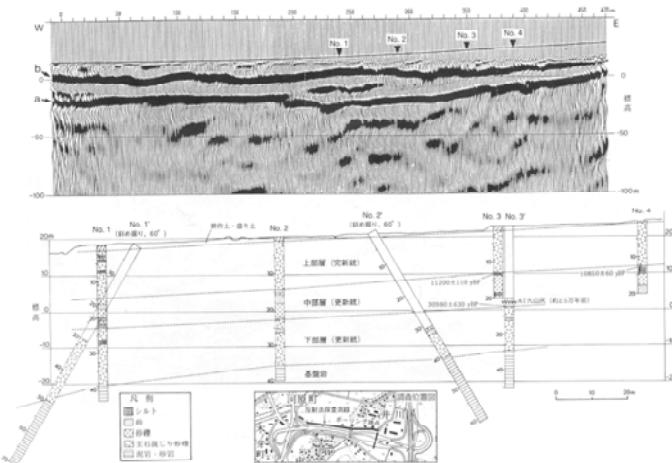
第2図 敦賀市井川における敦賀断層北部の反射法地震探査及びボーリング調査結果。
