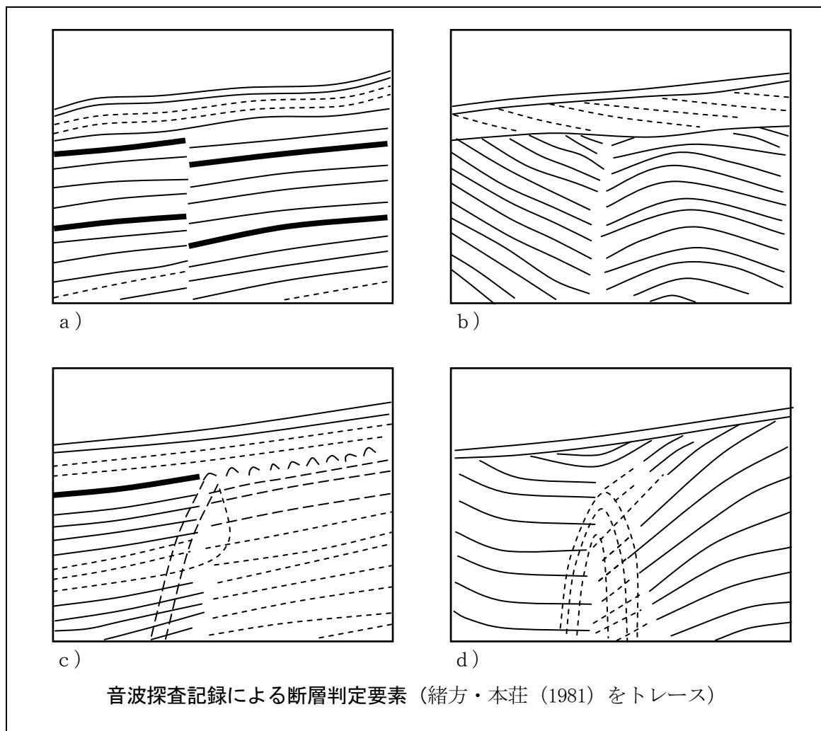
【事例4. 3-2：海上音波探査による断層関連褶曲（逆断層）の評価結果の事例】
