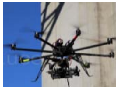
ドローン等による施設の点検
