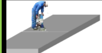
刃抜きによる検査
