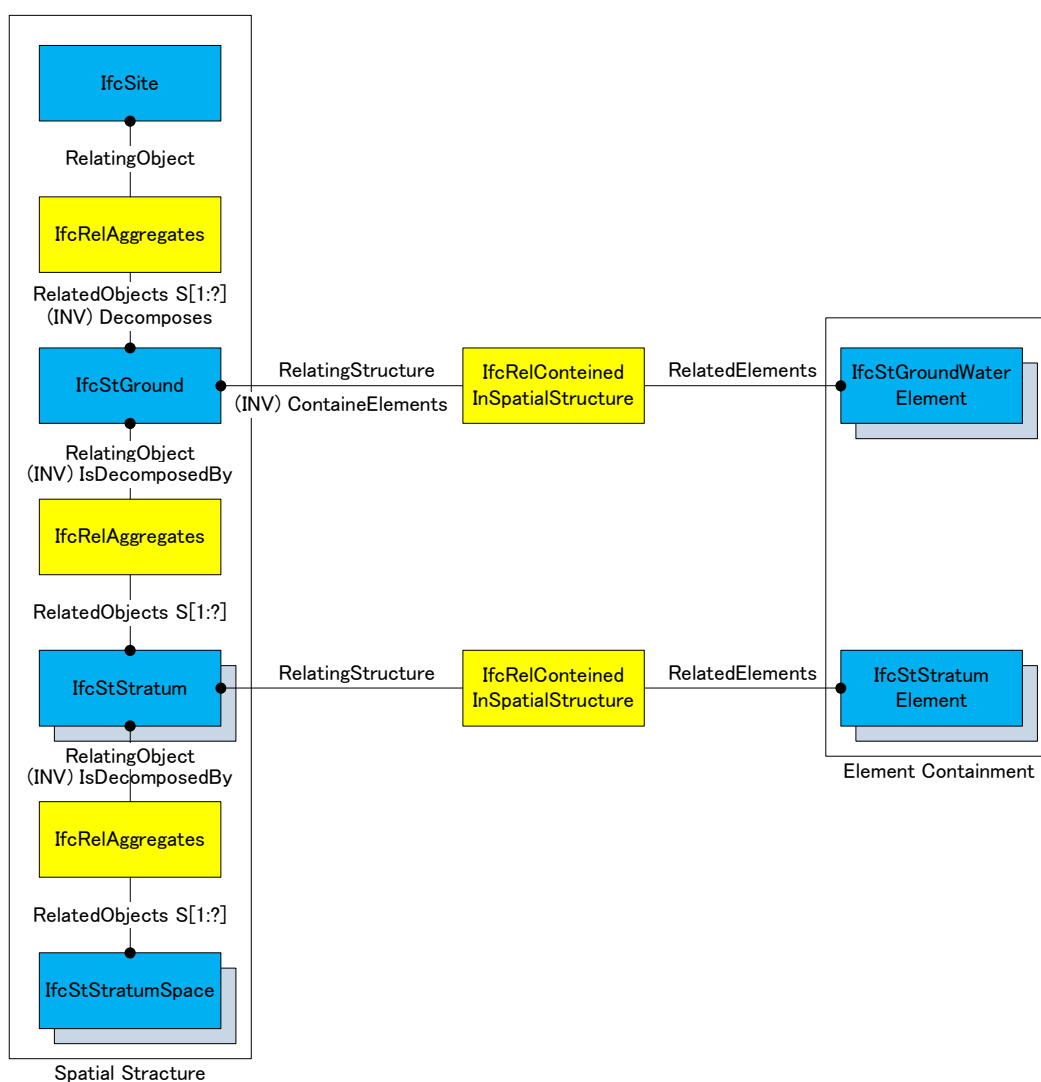
図 5.1.1 地盤に関するリレーション構成例
