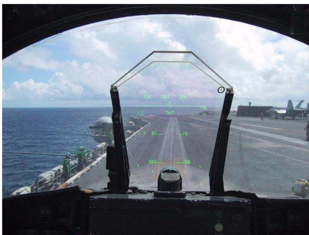
図 2-26 HUD を使った重畳表示 (戦闘機のコックピット)
